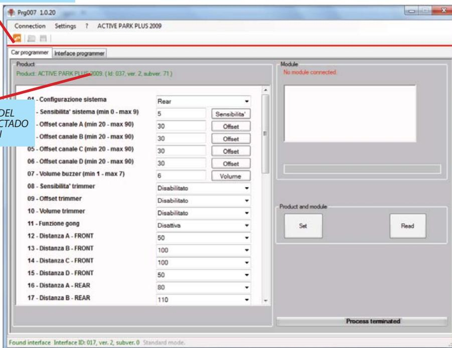
Una vez se han modificado las funciones y configurado los controles del módulo deseados, se puede transferir la programación con el **control "SET"**. Las funciones modificadas se ponen de color rojo. El **control "READ"** permite leer las configuraciones efectuadas.
